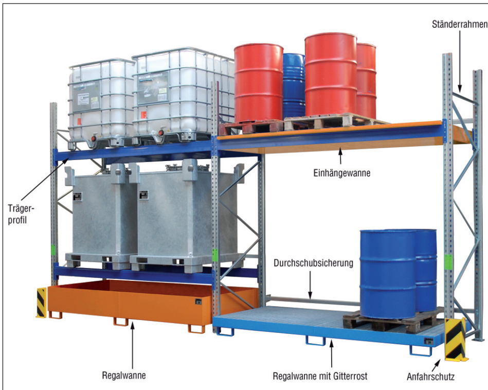
PR Set 1 für max. 12 x 200-l-Fässer bestehend aus: 2 x Ständerrahmen Typ PR-S 2000 2 x Trägerprofil Typ PR-T 2700-1 2 x Durchschubsicherung Typ PR-D 2700 1 x Regalwanne Typ RW-GR 2700-1 Zubehör: Anfahrerschutz (pro Stck.)
