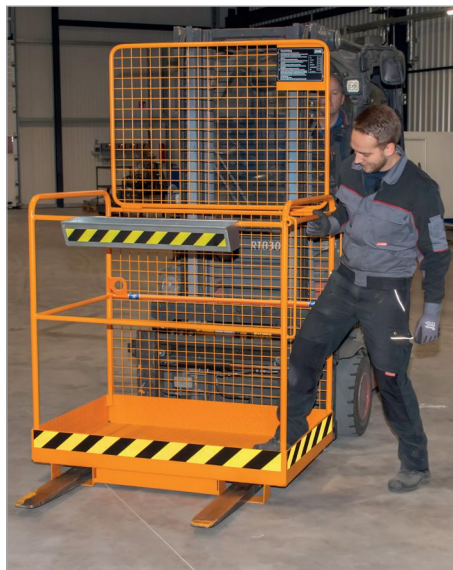
Einstieg durch Heben der Sicherungsstange
