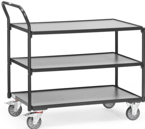
Leichter Tischwagen aus Stahlrohr und Profilstahl geschweißt, pulverbeschichtet anthrazitgrau RAL 7016. Schraubkonstruktion. 3 Böden aus Holzwerkstoffplatte, Oberfläche mittelgrau, im Stahlrahmen liegend mit 12 mm hohen Rand. Schiebegriff hochstehend. 2 Lenk- und 2 Bockrollen, TPE-Bereifung, Naben mit Rillenkugellager. Feststeller an den Lenkrollen, gemäß der Europäischen Norm EN 1757-3 (Sicherheit von Plattformwagen). Tragkraft obere und mittlere Ladefläche 80 kg.
