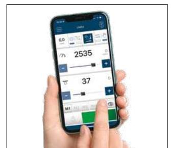
Neben der Einstellung der Streubreite lassen sich auch alle anderen Schaltfunktionen am Bedienteil bzw. via App vornehmen z. B. Ein/Aus, Schiebereinstellung zur Streuendosierung, Spannung prüfen, Leermelder einstellen etc. Zudem warnen App und Bedienteil optisch und akustisch u. a. bei Nicht-Erreichen der Schieberposition und Erreichen der Mindestmenge im Behälter etc. Die LISA App-Steuerung bietet dank serienmäßiger AUTO-DOSIS zur geschwindigkeitsabhängigen Dosierung noch mehr Komfort.
