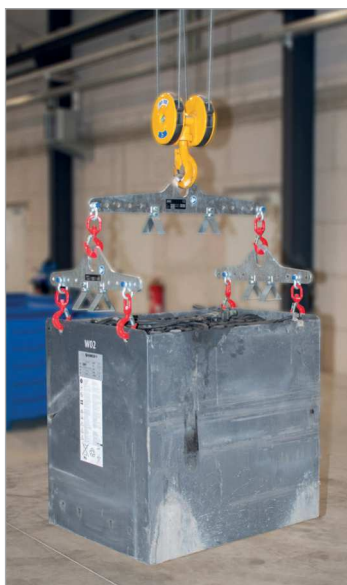
Kombination aus mehreren Traversen zur H-Traverse
