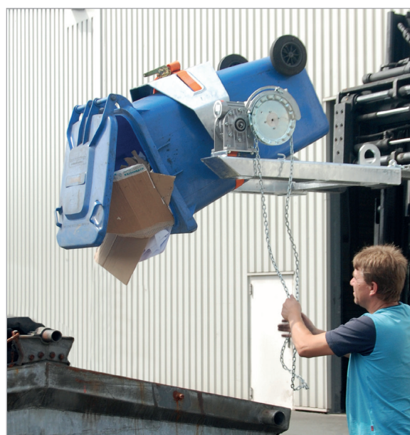
FLEX-K, Entleerung 240-l-Müllbehälter
