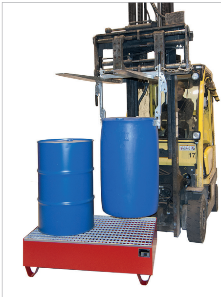
Aufnahme mittels Gabelstapler
