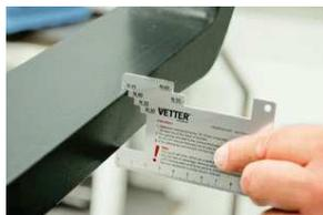
Mit der VETTER Messkarte ist ein Verschleiß schnell festzustellen. Die der Nenndicke n (z. B. n 40 für 40 mm Nenndicke) zugeordnete Öffnung im Bereich des größten Verschleißes anlegen (oftmals im Knickbereich).
